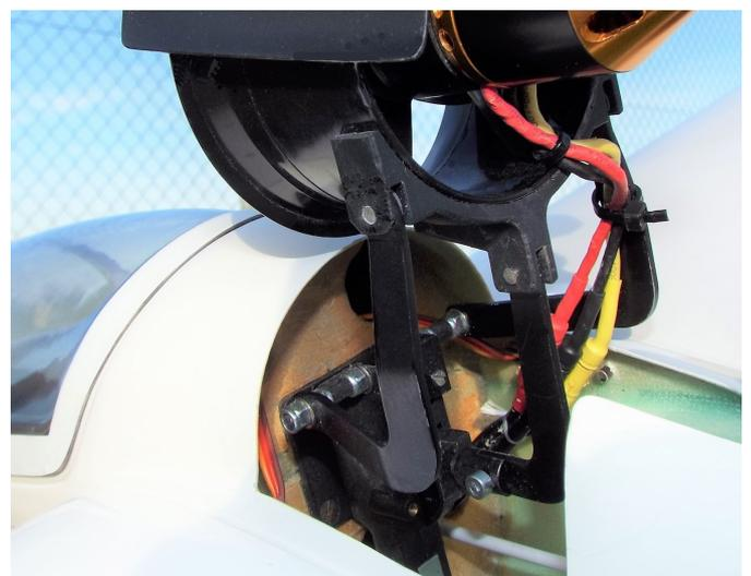
Der Seglerrumpf muss mit einer entspr. Öffnung versehen werden, das ausgeschnittene Teil kann später als Abdeckklappe dienen. Um das Risiko einer arbeitsintensiven Nacharbeit bei einem Fehlschnitt zu minimieren, ist es eine gute Idee, den Rumpf an dieser Stelle vor dem Schnitt abzuformen, um bei Bedarf schnell eine neue Klappe anfertigen zu können.
