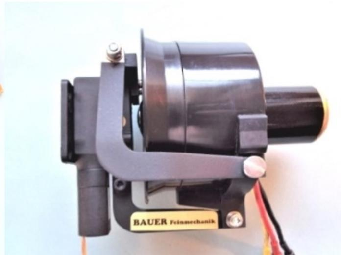
Impeller-Klapptriebwerkmechanik mit Spannring (ohne EDF)
