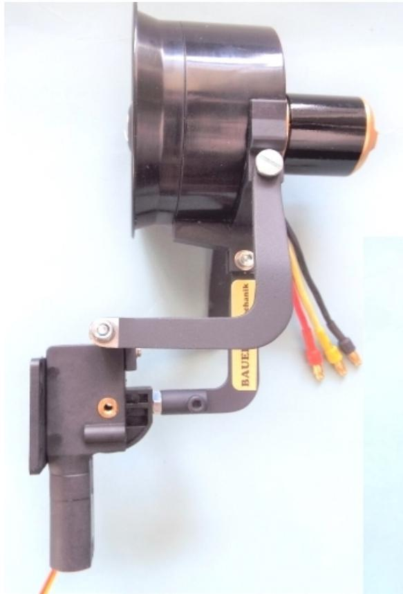
Impeller-Klapptriebwerk 64 mm
